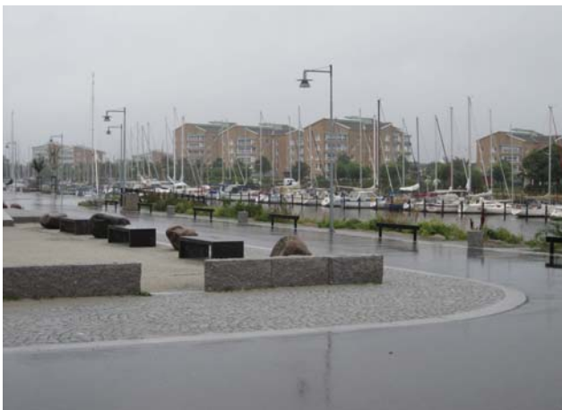
Avkörningskydd som även fungerar som sittplatser markerar kajkanten. (Lomma)
