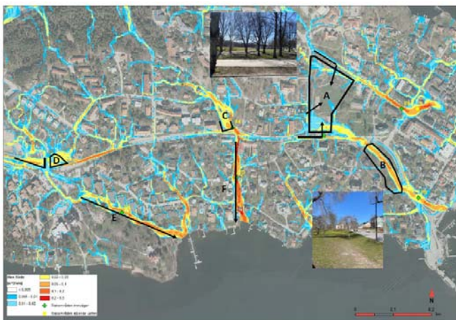
Figur 39: Förslag på skyfallsåtgärder i centrala Vaxholm. A: Parken Lägret, B: Officersparken C: Lågpunkt på lekplats D: Stor lågpunkt med flödet över vägen. E: Skyfallsled för kontrollerad avledning. F: Skyfallsled för kontrollerad avledning.
