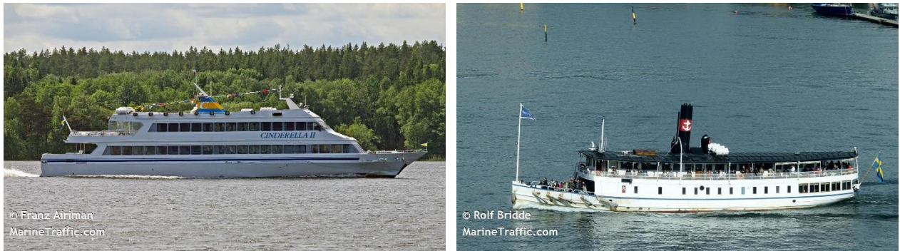
Figur 16. Cinderella II, L 42 m, B 7,7 m, gjorde 500 passager 2022 (till vänster) och Östanå 1; L 35 m, B 6,2 m (till höger).
