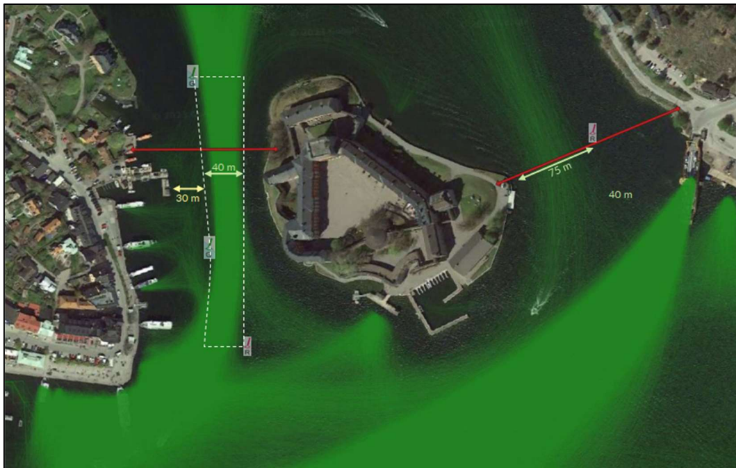
Figur 13. Flygbild med registrerade AIS fartygsspår år 2022. Områden med tätast grön nyans representerar de mest trafikerade stråken. Tillgänglig farledsyta för passerande fartygstrafik i sundet väster om Kastellet markerad med vit streckad linje (RISE, 2023).
