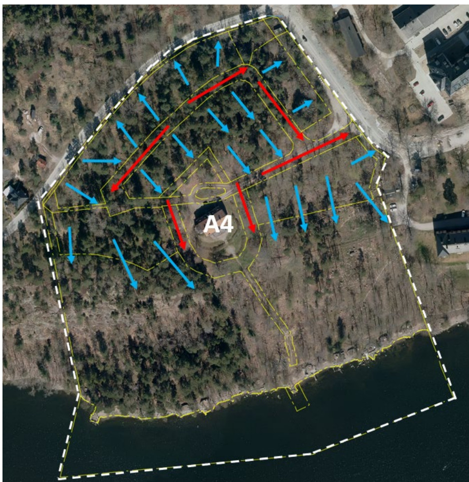
Figur 29 - Flödesriktningar (blå pilar) för dagvatten inom delområde A4. Röda pilar representerar flödesriktningarna på gata och i föreslagna svackdiken.
