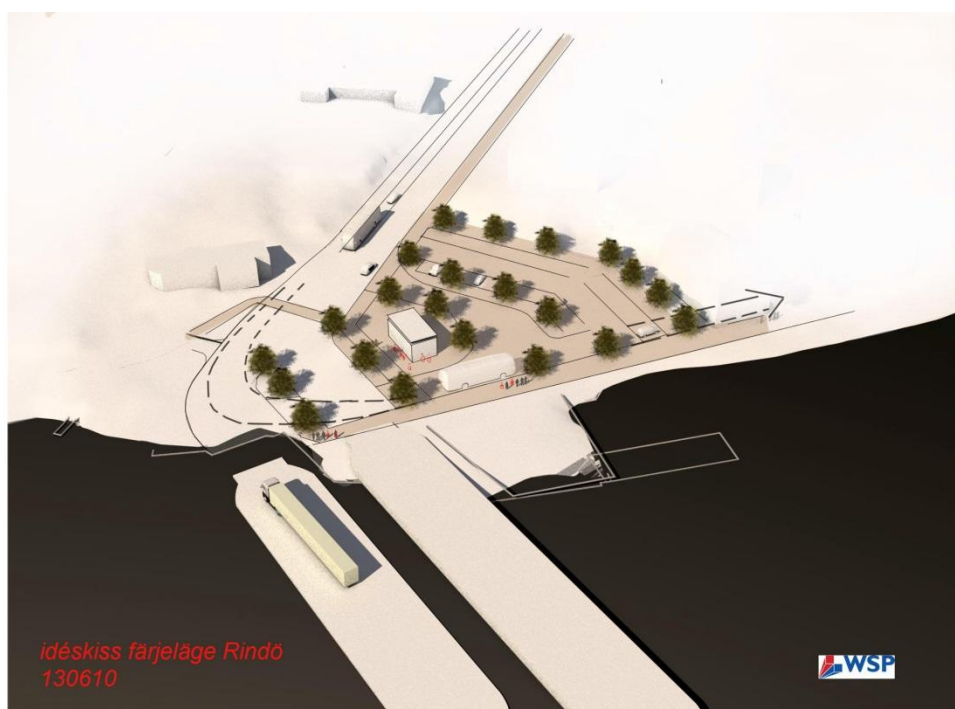
Figur 6. Idéskiss över färjeläge, med dubbla färjelägen och en ny utformning av planen inklusive möjlig väntsal/servicebyggnad.
