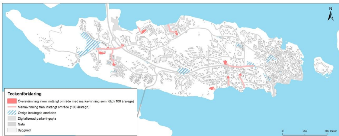
Figur 11 Instängda områden som fullständigt översvämmas och markavrinning till närmaste nedströms instängda område alternativt avrinning direkt till havet. Resultatet avser situation med 100-årsregn.
