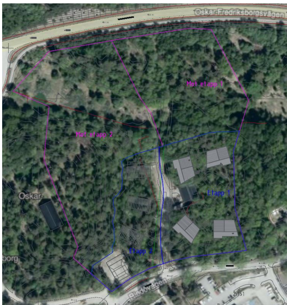
Figur 3.1. Etapp 1 och 2 markeras med blå linjer och intilliggande naturmark där avrinning bedöms ske mot detaljplaneområdet markeras med magenta.
