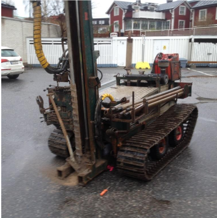
Foto 2: Borrning av BH6. Förorenad jord dokumenterades mellan 0,5-1,1 m u my. Berggrunden påträffades vid 1,1 m u my.
